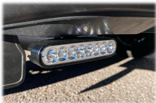
Arbetsljus/backljus under stötfångare. Kopplade via 3-lägesbrytare i hytt. (finns även med integrerat blytljus)
