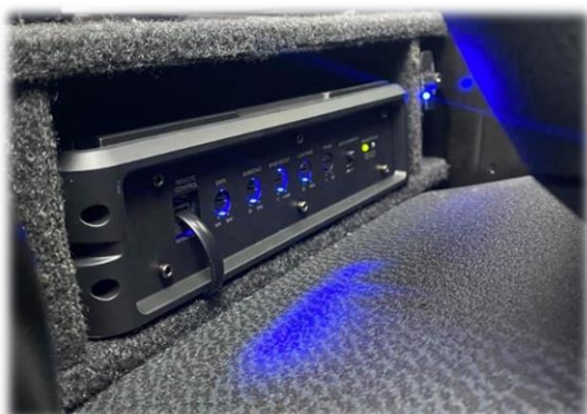
Ljudpaket med 8'' eller 10'' bas, kopplas över originalradion. (alla originalhögtalare byts ut)
